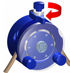
4. Schlauch straffziehen und Schlauchkassette einsetzen
